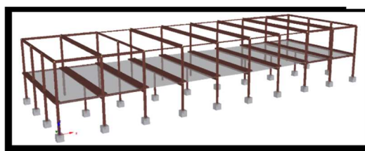
Figuur 4: Voorbeeld van een momentvast raamwerk uit staal (links) en beton (in langsrichting) (rechts)
