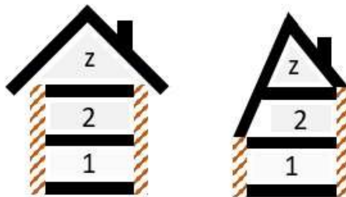
Figuur 11: Voorbeelden van doorsnedes met 1 bouwlaag met opgaand metselwerk.
