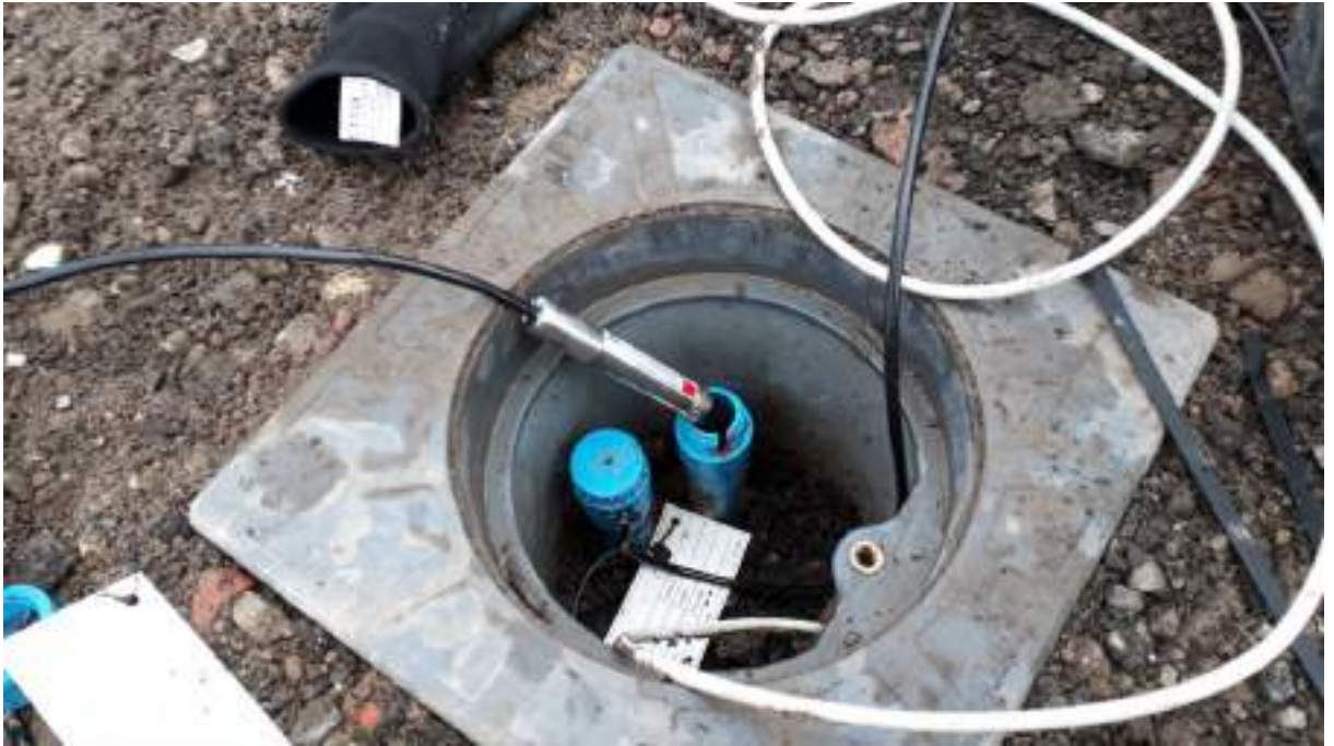
Figuur 34: Plaatsing druksensor in peilbuis
