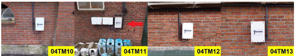
Figuur 5.3: Sensoren op object 04 met een blijvend verschuivend meetbeeld in de gemeten tilt in februari 2022.
