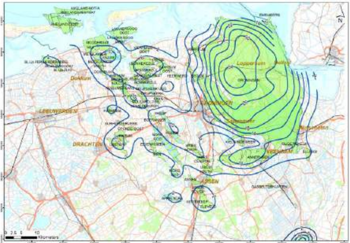
Figuur 21; Contourkaart voor bodemdaling door gaswinning opgetreden tussen start van de productie en de waterpassing in 2018, bepaald met het aan de metingen gekalibreerde geomechanisch model (cm). De gearceerde velden zijn de in 2020 niet producerende velden of de UGS-velden (Norg en Grijskerk).
