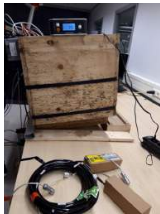
Figuur 46: Positie 4 en 5: kanteling om de x-as (z-waarden veranderen positief en negatief)
