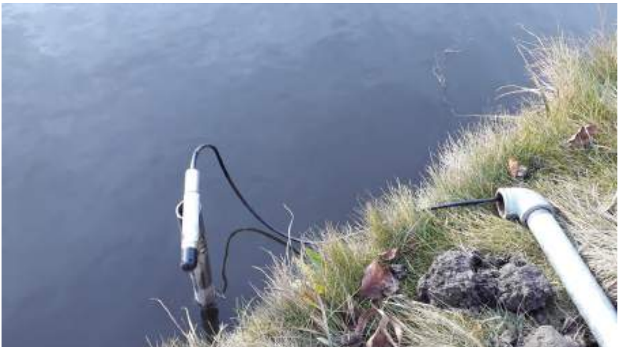
Figuur 35: Plaatsing open water sensor
